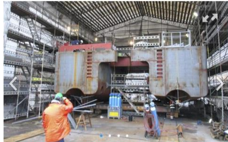
Manglar sikring: Arbeidstilsynet reagerer på at arbeidrarar frå NV Service jobbar på dette skroget til Kystverket utan at dei er sikra mot fall. (Foto: ARBEIDSTILSYNET)
